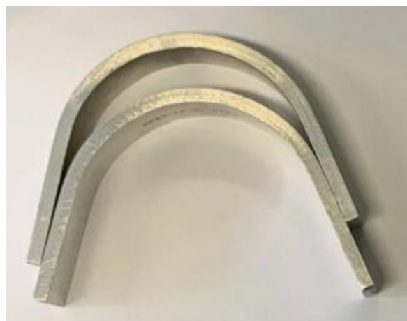
Assemblages soudés après test de pliage
